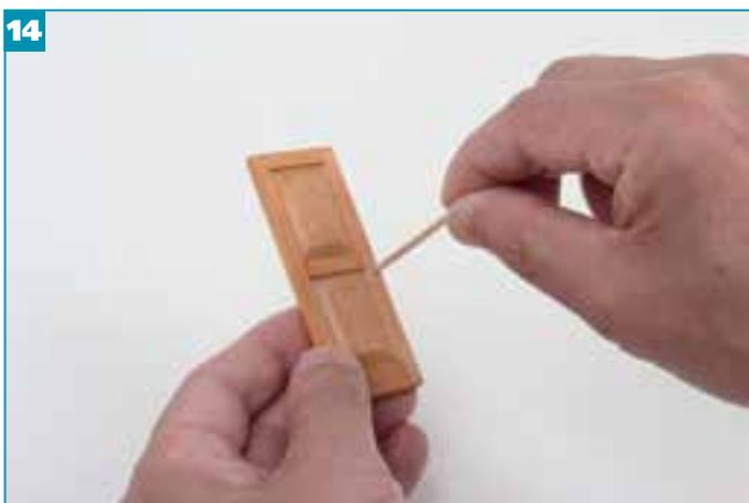
**14** Если после окрашивания отверстие в рейке В заполнилось краской, прочистите его при помощи зубочистки.
