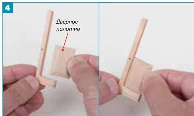
**4** Вставьте в желобки вертикальной и нижней реек дверное полотно, предварительно нанеся на края полотна клей.
