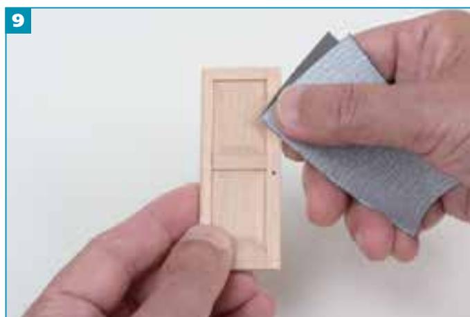
**9** Перед окрашиванием обработайте дверь наждачной бумагой, чтобы удалить шероховатости.
